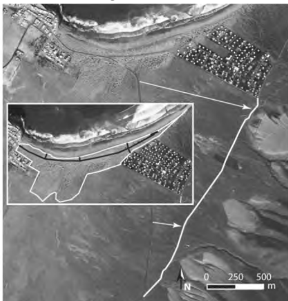
Figura 7. Alternativa de gestión en la que se elimina la carretera que cruza las dunas reforzando la carretera que lleva a la parte trasera de la urbanización. En el recuadro se muestra un ejemplo del acordonamiento del sistema de dunas, la ubicación de la pasarela de madera y la reubicación de los bungalows afectados por el manto eólico en el rectángulo interior de la urbanización
