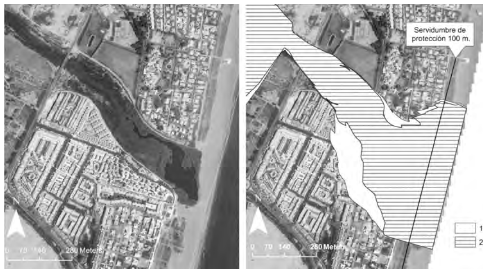
Figura 9. Desembocadura río Antas. Panel izquierdo vuelo fotogramétrico 2007, Junta de Andalucía. Panel derecho: 1, DPMTeH para el estado meteorológico considerado. 2, DPH usando la metodología actual definida en el marco legal vigente, franja de 100 m de servidumbre de protección (LC)
